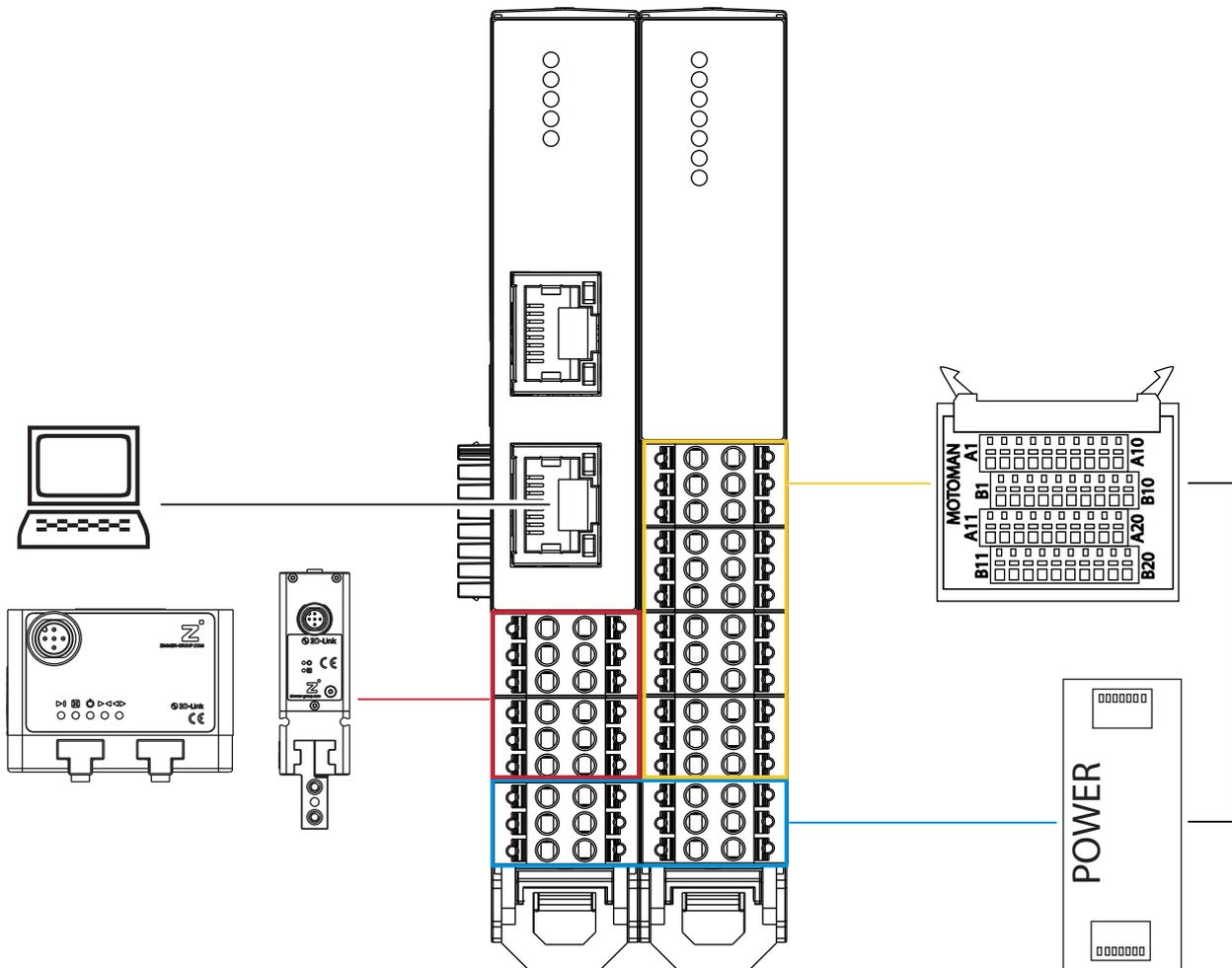
Die Standardverdrahtung entspricht der Standardkonfiguration in der Comfort App. Wenn Sie die Standardverdrahtung durchführen und die Standardkonfiguration in der Comfort App beibehalten, funktionieren Ihre Greifer mit dem Roboter.
