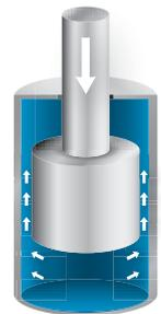
El aceite sale constantemente a través de las dos boquillas. Las ranuras de la carcasa permiten un desarrollo de la sección transversal individual.
