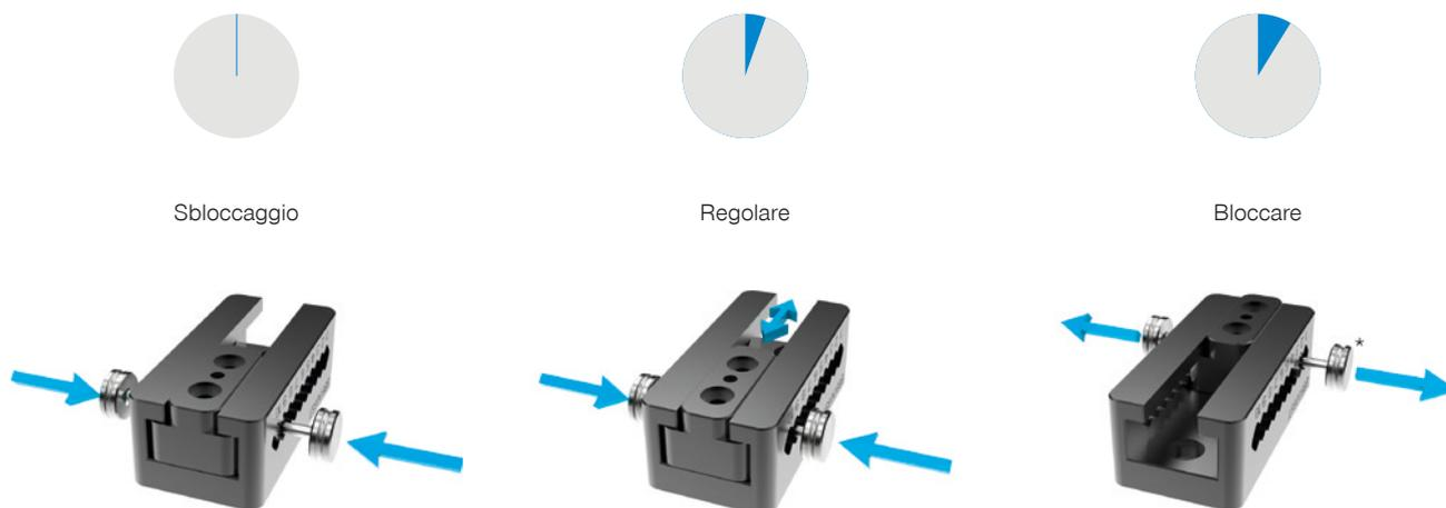
\* I tasselli di spinta sono avvitati e possono essere eliminati per minimizzare il profilo d'interferenza
