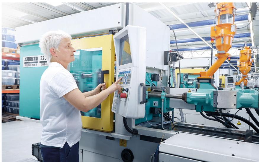
Unsere Spritzgießfertigung ist aber auch in jeder anderen Hinsicht auf dem Stand der Technik: Wir haben zum Beispiel eine vollautomatische Materialzufuhr, bei der die Rohpellets von einem zentralen Lager mit integrierter Trocknung über das Rohrleitungssystem unserer zentralen Förderanlage zu den Spritzgießmaschinen gefördert wird. Damit sorgen wir für eine wirtschaftliche Produktion mit kurzen Reaktionszeiten, auf die Sie sich jederzeit verlassen können.
