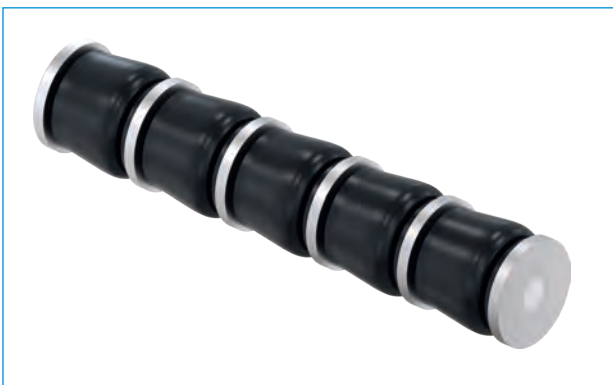
▶ 큰 스트로크를 통해 적은 지지력으로 완충하기 위해 내장된 둥근 로드 가이드를 포함하여 여러 BasicStop Axial Standard를 직렬 연결
